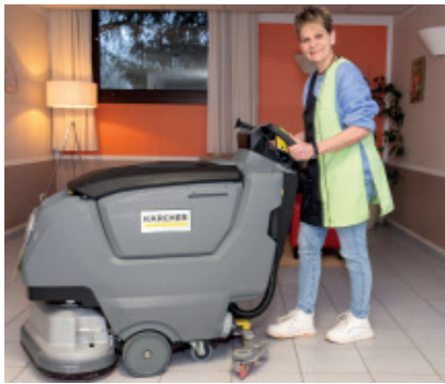
Beim Einsatz von Reinigungsmaschinen werden Putzmittel und Wasserverbrauch besser und gleichmäßiger dosiert.
